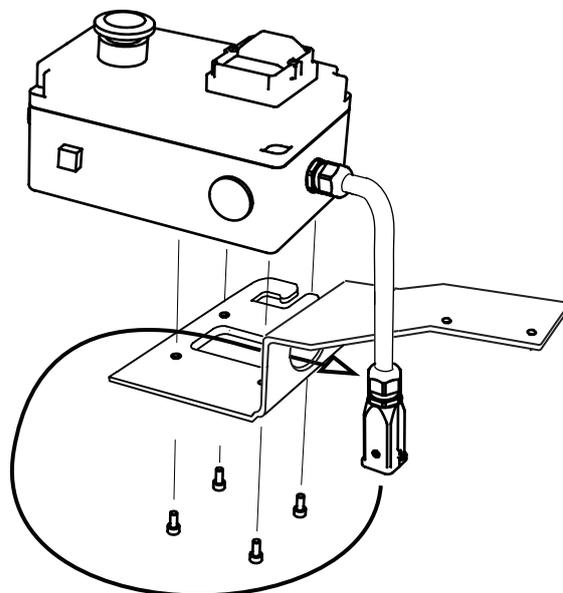
Para colocar la manivela en la sierra eléctrica, primero retire la empuñadura y, a continuación, coloque la manivela con la plantilla de orificios existente y los tornillos originales. Ensamble en el siguiente orden: manija, mango de soporte + caja eléctrica, carro de motosierra y luego la manivela debajo del carro de motosierra.
