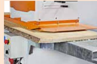
La pieza de trabajo abre la cubierta lateral cuando está canteando tablones más anchos que la máquina.
