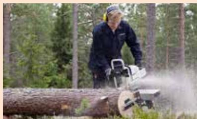
Ajusta el carril guía y sus sujetadores al tronco. Instala el Logosol Timberjig a la motosierra. ¡Y estas listo para aserrar!
