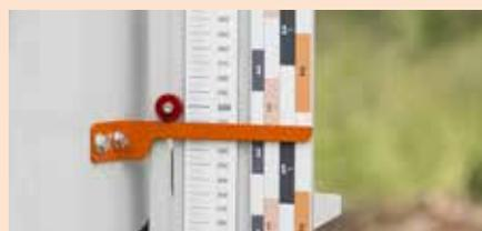
Un indicador único del último corte en la escala le ayuda a preparar su próximo corte. Esto facilita e incrementa su producción
