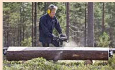
Los primeros cortes se hacen con la ayuda del carril guía. Los ángulos fijos y niveles predeterminados para la anchura y grosor de la troza aseguran un simple ajuste.
