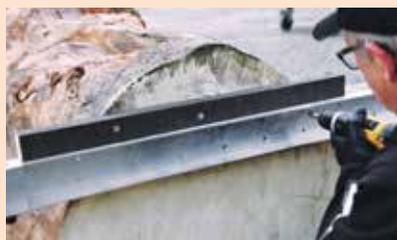
Coloque y sujete los carriles guía en el tronco, a la altura de su primer corte. El marco de sierra está montado y se desliza fácilmente sobre los carriles guía.
