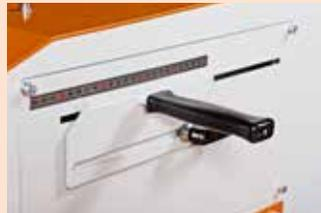
Establezca la anchura deseada haciendo uso de las escalas visibles para facilitar el ajuste.
