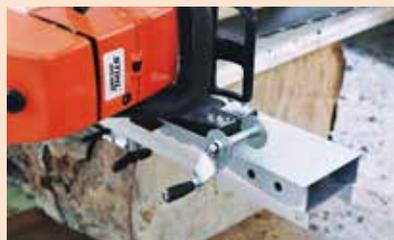
El marco de sierra es empujado hacia adelante con una manivela. Trabajar con este método es fácil y proporciona una presión estable y uniforme a través del carril guía.
