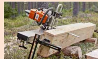
Cuando se han cortado tres lados del tronco, usted puede comenzar a aserrar sus tablas y tablones. El carril guía asegura una gran precisión através de todo el tronco.
